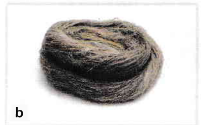
Abb.5 Textilfasern: a – kurze (aus Asbest); b – lange (aus Flachs)
